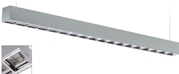
Entreplantas escaleras y halls: Suministro e instalación de luminaria LAMP 14741410 FIL + LED G2 OPAL SUS 4600 WW WH + CPE19746, que consiste en una estructura de luminaria para suspender o adosar fabricada en extrusión de aluminio lacado en color blanco satinado, de dimensiones 1700x50x67 mm y 2,7 kg de peso, con lámpara LED MID-POWER, de 28 W, temperatura de color blanco cálido (3000 °K, IRC:80 y MacAdam:3) y difusor de policarbonado opal. Clase de aislamiento I. Grado de protección IP42.
